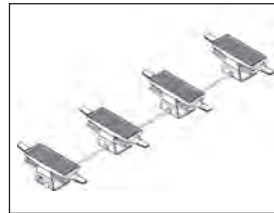
Anwendung B: 1 Basismodul + maximal 3 Erweiterungsmodule mittels Zwischenkabel für den Gebrauch auf länglichen Tischen.
